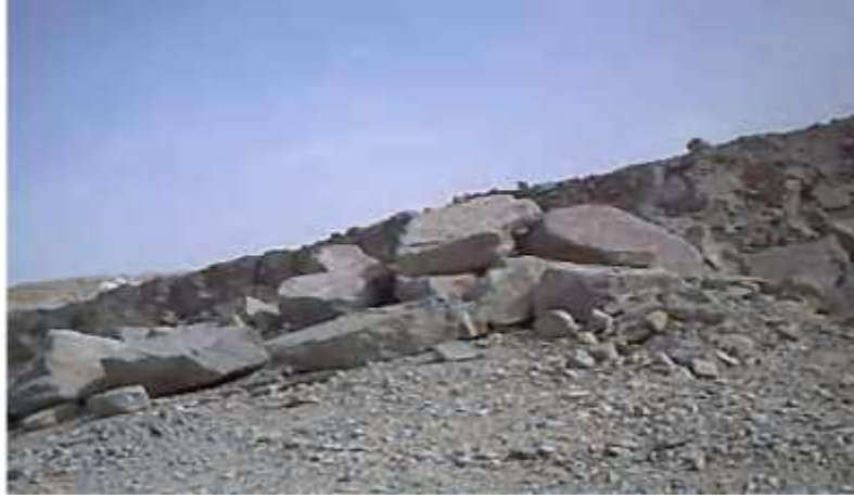
الشكل 2: الكتل الضخمة الناتجة بعد عملية التفجير
